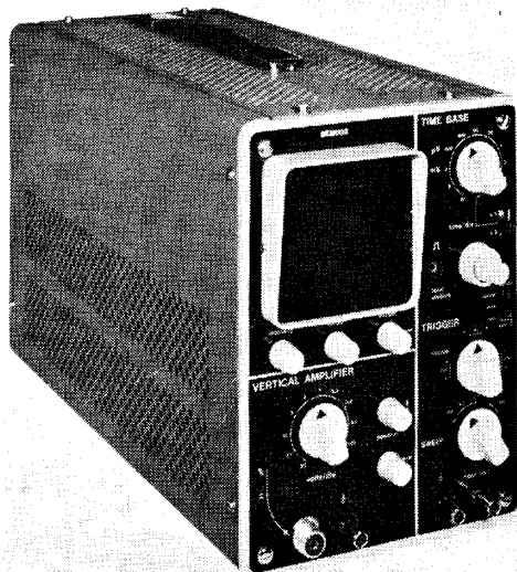
Dit is de oscillograaf BEM-005, gemaakt volgens de gegevens van Philips en met de in het pakket beschikbare onderdelen. Deze oscillograaf voor eenvoudige meetdoeleinden is niet van een fabrieksinstrument te onderscheiden.
